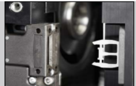
Cierres específicamente seguros: sistema de cierre instantáneo de la cámara de moliendo
